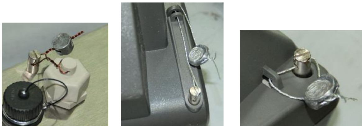
Рисунок 2 — Схема пломбировки весов от несанкционированного доступа
